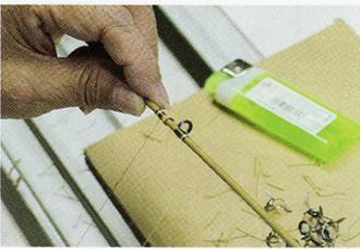
ガイド取り付けに使われる糸は数十種類の色でデザインされ、すべて手作業で巻き付けられる。
