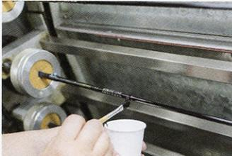
チェック後のガイド部は、独自設計した機械を用いて、1箇所ずつ手作業で接着塗装される。
